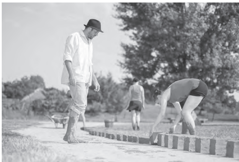
Obr. 1., 2. Příprava hlíny na výrobu nepálených tehál a obracanie obschnutých nepálených tehál. Muzeum vesnice jihovýchodní Moravy Strážnice, júl 2013. Foto David Rájecký
